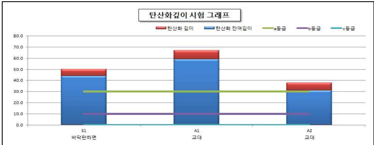
【그림 2.4.4】 탄산화 깊이 측정결과
